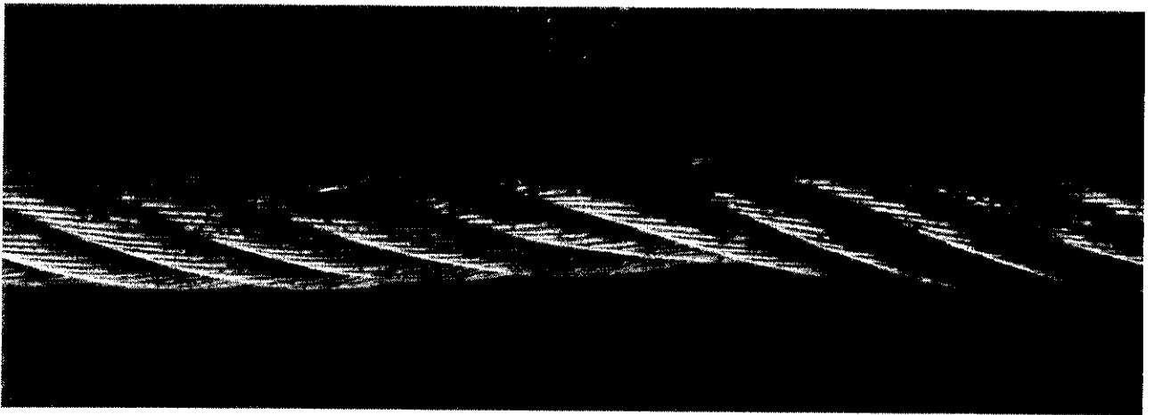
Рисунок П 2.2. Местное уменьшение диаметра каната
